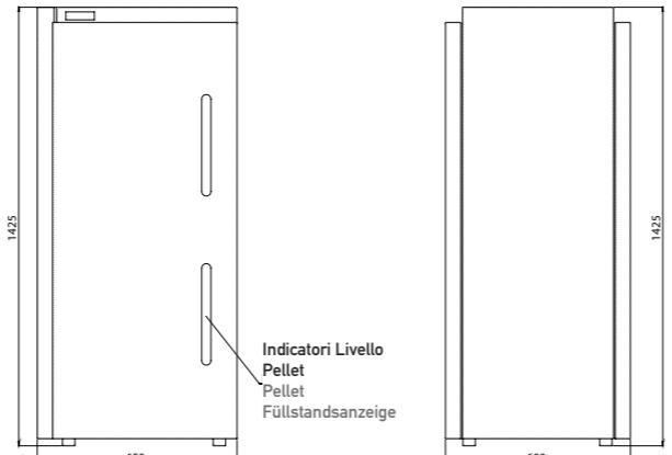
Il serbatoio supplementare, completamente automatico, può essere collegato direttamente alla caldaia, oppure separatamente. La capienza di 250 kg assicura una grande autonomia.
